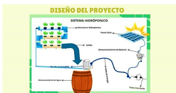
Figura 1. Prototipo del sistema hidropónico, con utilización de paneles solares, tanque de almacenamiento con bomba sumergible y estructura de PVC.
