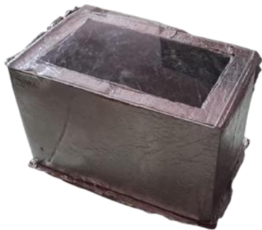
Figura 1. Horno Solar Tipo Caja.
