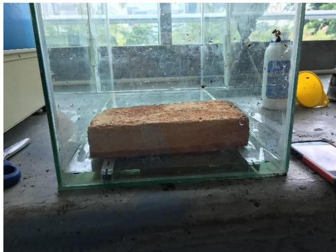
**Figura 7:** Ensayo de Tasa Inicial de Absorción
