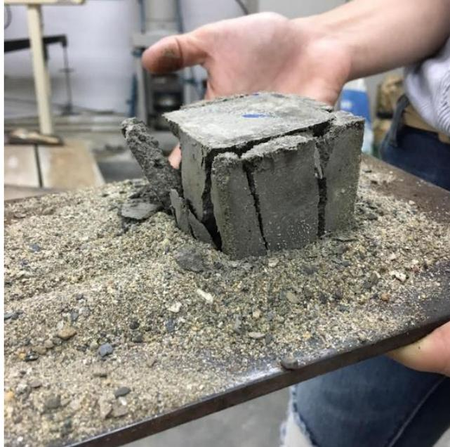
**Figura 9:** Cubo de mortero luego de ser sometido a compresión
