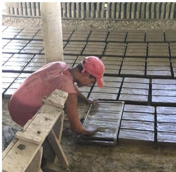
**Figura 3:** Moldeo de ladrillos en adoberas o moldes
