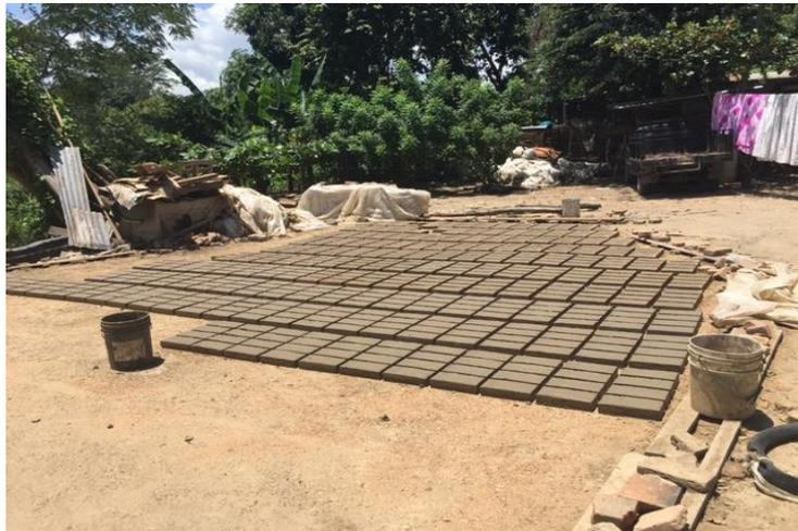
**Figura 4:** *Secado de ladrillos al aire libre*
