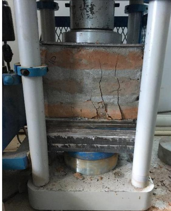
**Figura 8:** Prueba de resistencia a la compresión de los ladrillos ligados
