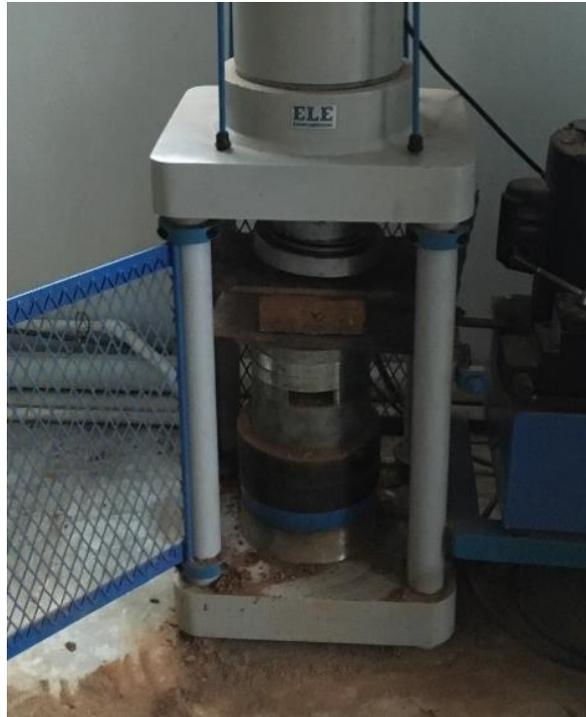
**Figura 5:** *Ensayo de Resistencia a la Compresión*
