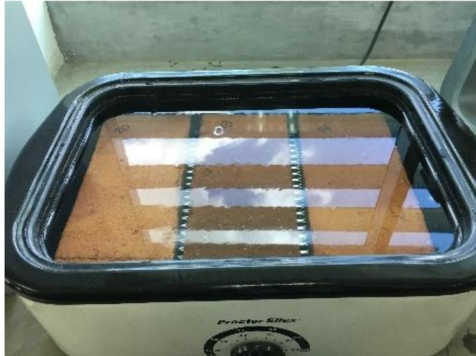
**Figura 6.:** Realización de prueba de absorción de agua
